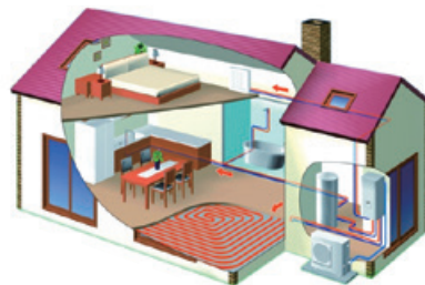
暖房・給湯を行うATW（イメージ） ATWやエアコンに使われるヒートポンプ技術は、空気中の熱を集めてより大きなエネルギーに変えるため、化石燃料機器と比べ、省エネ性が高く温室効果ガス排出量の低減にも貢献します。
