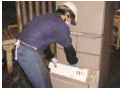
廃冷蔵庫からの野菜室取り出し (富士エコサイクル)
