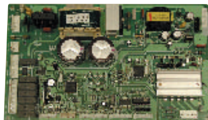
冷蔵庫の制御基板(鉛フリー化)
