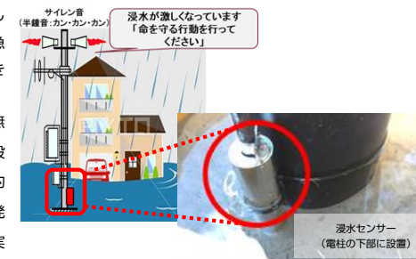
長野県飯田市様で実証実験を行った 浸水アラートシステム
