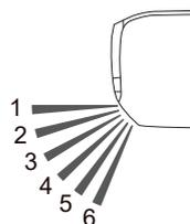
\* El rango del funcionamiento de vaivén depende de la dirección de flujo de aire establecida antes del funcionamiento de vaivén.
