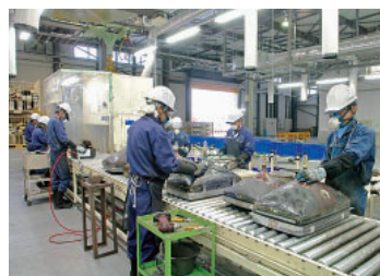
リサイクルプロセスの効率化を 進めたテレビの分解工程ライン
